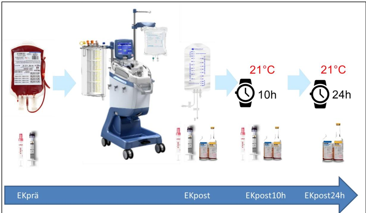
**Abb. 1** ▲ Schematische Darstellung des Versuchsablaufs mit Messpunkten: EKprä (vor MAT-Waschung, EKpost (nach MAT-Waschung, EKpost10h (10 h Lagerung im Retransfusionsbeutel bei Raumtemperatur) und EKpost24h (24 h Lagerung im Retransfusionsbeutel bei Raumtemperatur)
